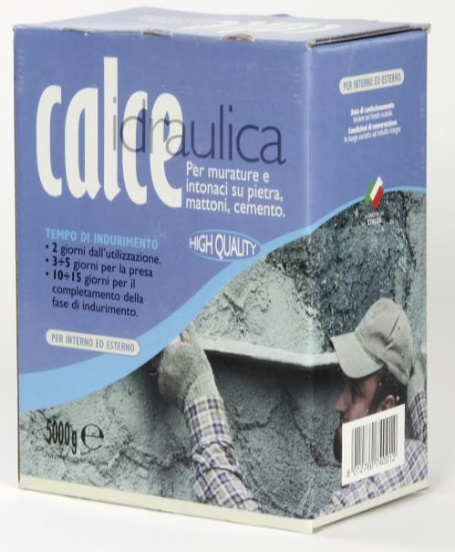
*Legante idraulico costituito da silicati ed alluminati di calcio, carbonato di calcio, pozzolana ed additivi che ne migliorano la lavorabilità. Prodotto conforme alla norma UNI 10892-1 per leganti idraulici da costruzione ed è classificato LIC 3,0. per malte di finitura e sottfondi e intonaci tradizionali.*
