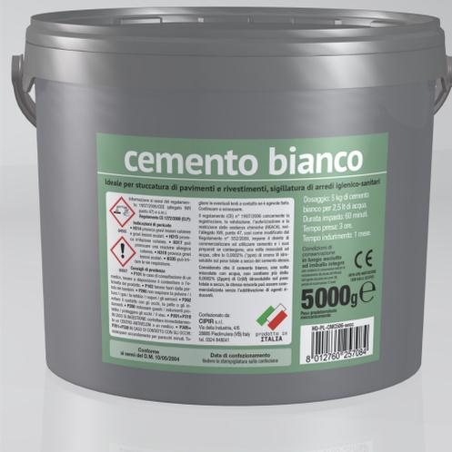
*Cemento bianco, costante e stabile che consente con l'aggiunta di pigmenti di ottenere la più versatile gamma di colori e grande purezza di tinta. Ottime resistenze meccaniche, il ritiro, il calore d'idratazione nonché il modulo elastico inferiore a quello del cemento grigio di pari classe, ne rendono idoneo l'impiego in realizzazioni particolari (pavimentazioni, pietre artificiali ecc.).*
