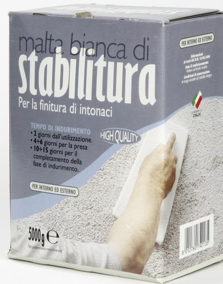
*Malta bianca di stabilitura è una malta premiscelata a secco composta da: cemento bianco, calce idrata, aggregato bianco ed additivi che migliorano la lavorabilità, l'adesione e la protezione agli agenti atmosferici. Il prodotto è conforme alla normativa UNI EN 998-1 ed è classificato come malta per intonaco di finitura GP CS II - W1.*
