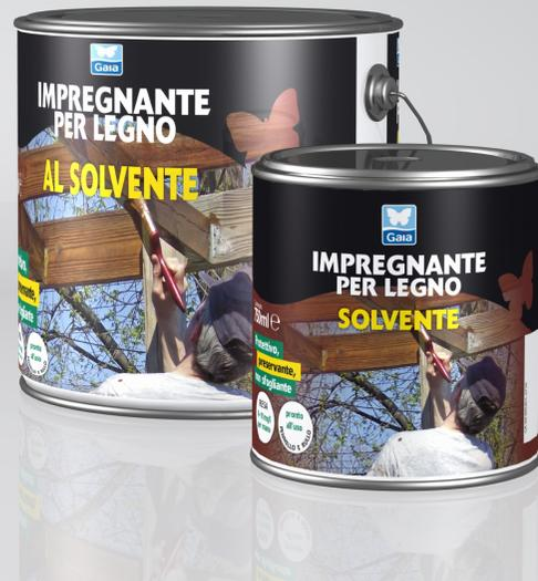
**CICLO:** Assicurarsi che il supporto sia perfettamente asciutto, pulito ed esente da impurità. Eliminare le eventuali piccole imperfezioni della superficie mediante carteggiatura, applicare quindi la prima mano di Impregnante al solvente nel colore desiderato. Solo dopo almeno 4÷5 ore, se necessario, si potrà applicare la seconda mano di prodotto.
