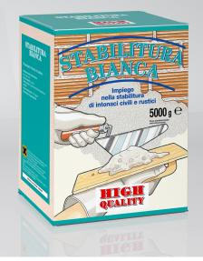
Stabilitura bianca è una malta premiscelata a secco composta da: cemento bianco, calce idrata, aggregato bianco ed additivi che migliorano la lavorabilità, l'adesione e la protezione agli agenti atmosferici. Il prodotto è conforme alla normativa UNI EN 998-1 ed è classificato come malta per intonaco di finitura GP CS II - W1.
