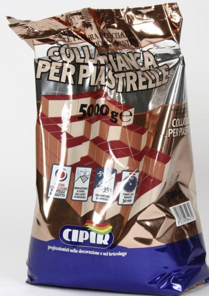
*Colla piastrelle in sacchetto è un premiscelato in polvere di colore bianco composto da: cemento portland, sabbie selezionate e specifici additivi atti a migliorare la lavorabilità e le caratteristiche fisico-meccaniche. Il prodotto è conforme alla norma UNI EN 12004 ed è classificato come C1 NPD, "non adatto per usi esterni".*
